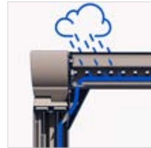
integrierter Wasserablauf über den Pfosten
